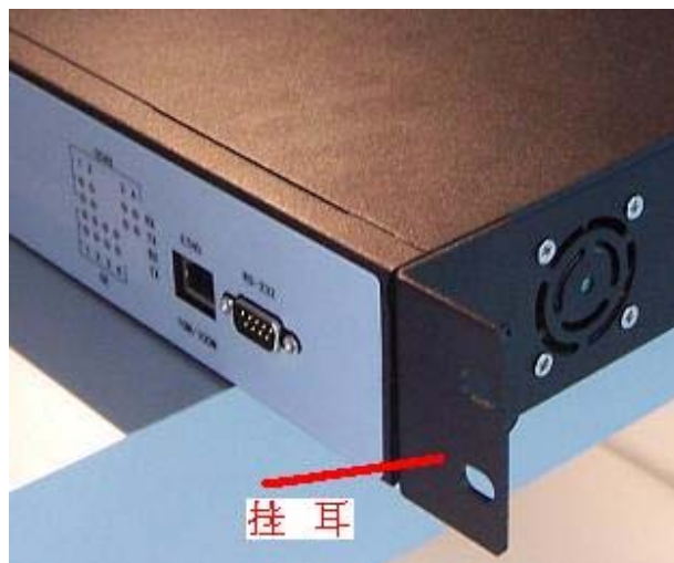
图 5-1 将挂耳固定在 FS3100 系列千兆设备的机箱上
