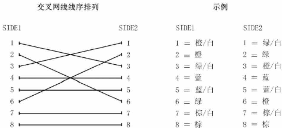
图 2-6 交叉网线制作示例图
